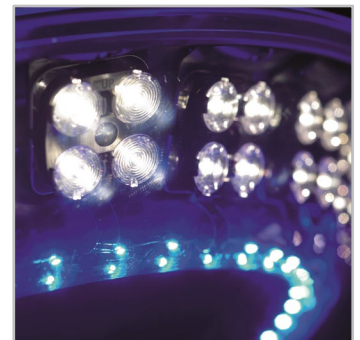
64 потужних білих світлодіодів розподілені на 16 модулів, кожен з яких має свою орієнтацію і нахил відповідно до необхідного типу розподілу світла.
