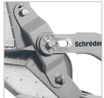
Конструкція кронштейна БРАЙТЛАЙН GEN2 дозволяє орієнтувати оптику по різним осям для точності фотометрії.
