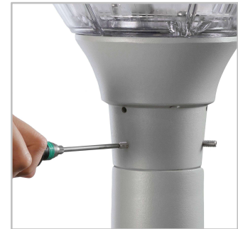
ХЕПІЛЕД має вінцеве кріплення на патрубку діаметром 60мм 6 гвинтами М6.
