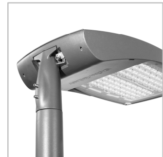
Серія TECEO GEN2 має універсальні вузли кріплення на внутрішню трубу діаметром від Ø32 до Ø76мм. Також доступна спеціальна вставка в Ø60мм.
