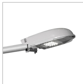
Точне налаштування на місці установки: кут нахилу від -15° до +5° для консольного монтажу, від -10° до +10° - для вінцевого з перехідником.
