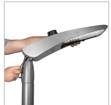
Кут нахилу можна регулювати на місці установки: для вінцевого кріплення - від 0 до 15°, для консольного - від 0 до -15°.
